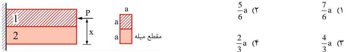
۷۹. در شکل زیر، برای خیز قائم نقطه B صفر باشد، نسبت  $\frac{a}{L}$  چقدر انتخاب شود؟
