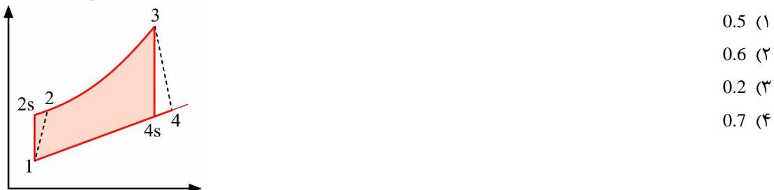
**۵۶.** ماشین حرارتی شکل زیر، که چرخه کارنو است به منبع حرارتی با دمای  $T_H$  (منبع گرم) و منبع حرارتی با دمای  $T_L$  (منبع سرد) متصل است. به علت مقاومت حرارتی، دمای گرم ترین نقطه ماشین ( $T_a$ ) با دمای منبع گرم ( $T_H$ ) اختلاف دارد، و مقدار حرارت منتقل شده برابر است با  $Q_H = K(T_H - T_a)$  که  $K$  مقدار ثابتی است.
